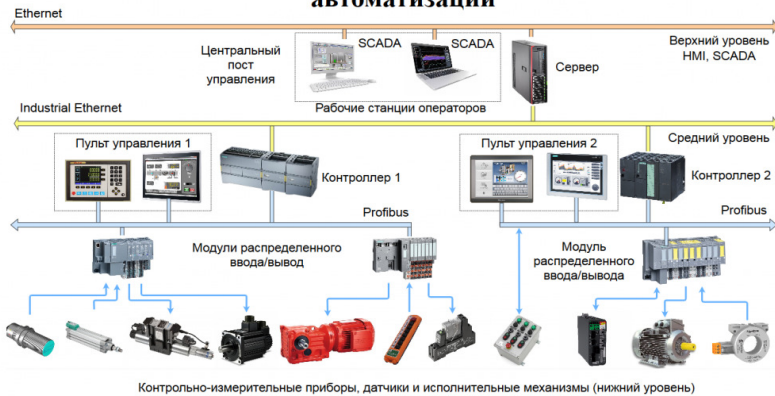
Рисунок 1 - Типовая структура промышленной системы автоматизации
