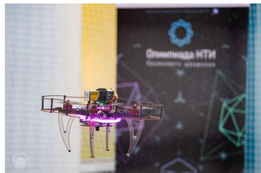
Конструктор состоит из популярных открытых компонентов, а также набора необходимой документации и библиотек для работы с ним. Набор включает в себя карбоновую раму, защиту опор, бесколлекторные двигатели, полетный контроллер СОЕХ Pix с полетным стеклом PX4, Raspberry Pi 4 в качестве управляющего бортового компьютера, модуль камеры для реализации полетов с использованием компьютерного зрения, а также набор различных датчиков и другой периферии.
