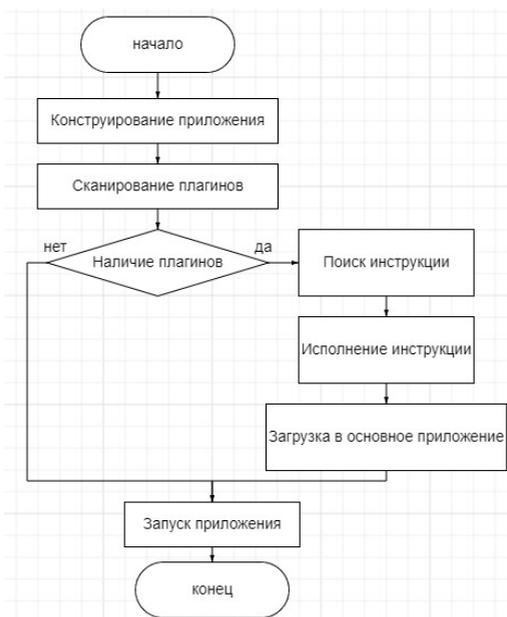
**Рисунок 11 – упрощенная схема работы загрузки плагинов**
