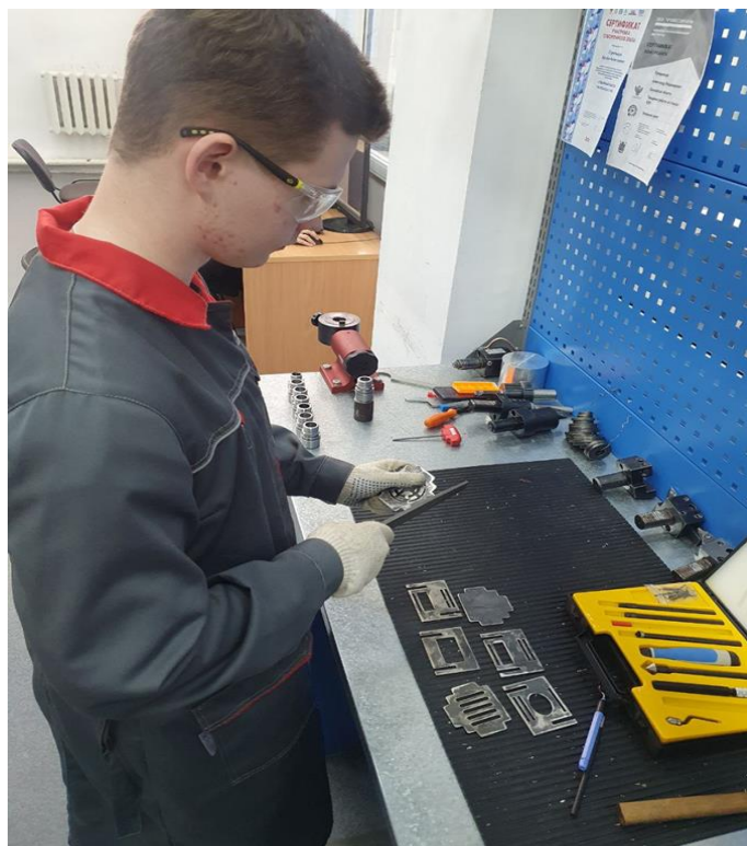
Рисунок 10-Притупление острых кромок
