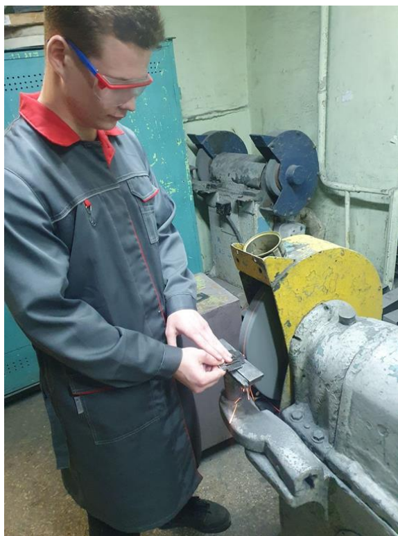
Рисунок 9-Снятие больших заусенцев
